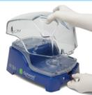
**B.** Retire a tampa da base, premindo o botão de desbloqueio preto. Coloque a tampa de lado.
