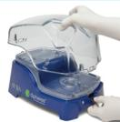
**B.** Odstranite pokrov s podnožja tako, da pritisnete črni gumb za odklepanje. Pokrov položite v stran.
