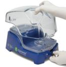
**B.** Ta bort locket från basen genom att trycka på den svarta upplåsningsknappen. Lägg locket åt sidan.
