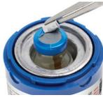
F. Conecte el filtro de 0,22 micras a la aguja de purgado de calibre 25G. Introdúzcala a través del tapón de goma del vial de envío de vidrio para crear un orificio de purgado. Asegúrese de que la punta de la aguja esté bien separada y no toque los contenidos.
