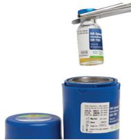
C. Determinați activitatea totală a microsferelor SIR-Spheres în flaconul de transport din sticlă folosind o cameră de ionizare corespunzătoare (calibrator de doză) și apoi puneți flaconul de transport din sticlă înapoi în recipientul de plumb.
