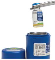
C. Determine a atividade total das SIR-Spheres no frasco de vidro de transporte, utilizando uma câmara iônica (calibrador de dose) adequada e, em seguida, volte a colocar o frasco de vidro de transporte no recipiente de chumbo.
