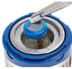
F. Ligue o filtro de 0,22 µm à agulha de ventilação de 25G. Insira-o através do septo de borracha do frasco de transporte para criar um orifício de ventilação. Certifique-se de que a ponta da agulha está bem afastada do conteúdo.
