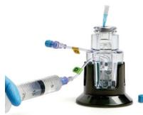
**E.** Desligue a seringa de purga da linha D; ligue uma nova tampa azul ao conector da linha D.
