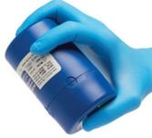
B. Abra rapidamente o recipiente de chumbo e retire o frasco de vidro de transporte com uma pinça.
