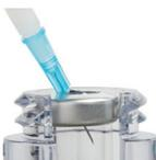
**B.** Certifique-se de que a ponta da agulha de ventilação está acima da marca do nível de enchimento.
