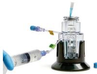
**E.** Koppla bort primingsprutan från D-slangen och sätt på ett nytt blått lock på anslutningen till D-slangen.
